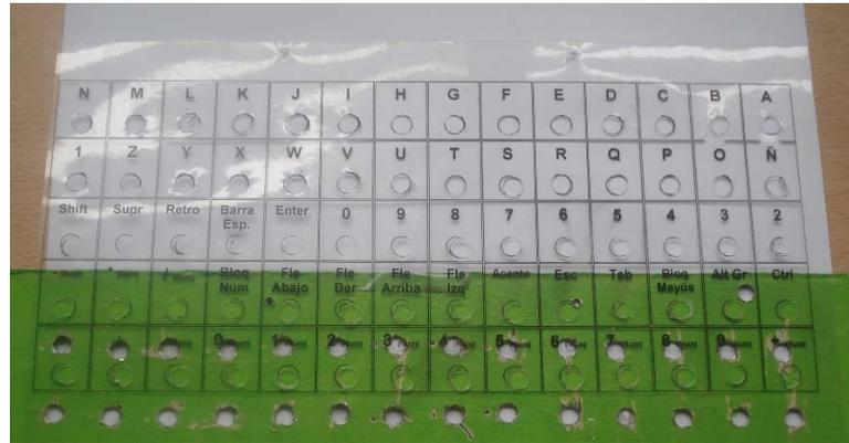
**Paso 7:** Colocamos la filmina impresa sobre una lámina de acrílico o plástico. Sostenemos con una prensa, y con un taladro (en este caso con mecha de 6mm) realizamos los agujeros.
