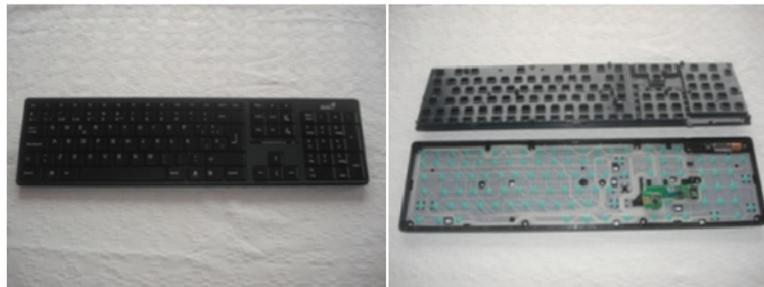
Las láminas 1 y 3 poseen pistas y contactos, y están separadas por una lámina transparente. La lámina 1 contiene los botones de silicona pegados. A cada tecla le corresponden 2 pistas, una de la lámina 1 y otra de la 3. Al presionar una tecla se unen los contactos de las pistas permitiendo al dispositivo identificar que tecla se presionó.
