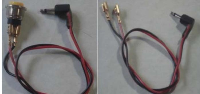
**Conexión para 1 o 2 pulsadores que permite activar una misma tecla, con terminales "faston" hembra, para atornillar a la plantilla.**
