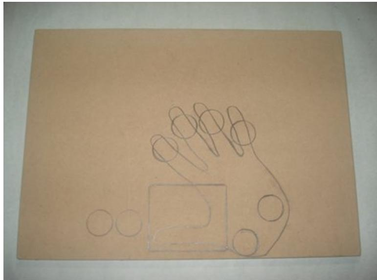
**Paso 2:** Con una mecha paleta de 3cm realizamos los agujeros para los pulsadores y con una sierra caladora cortamos el rectángulo que corresponde a la base de la palanca.
