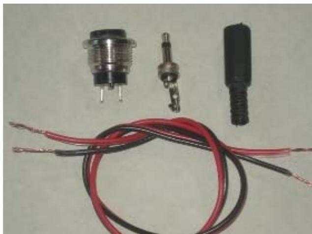
**Paso 1:** Colocamos el cable en las patas del pulsador, de adentro hacia fuera, y soldamos los cables con estaño.
