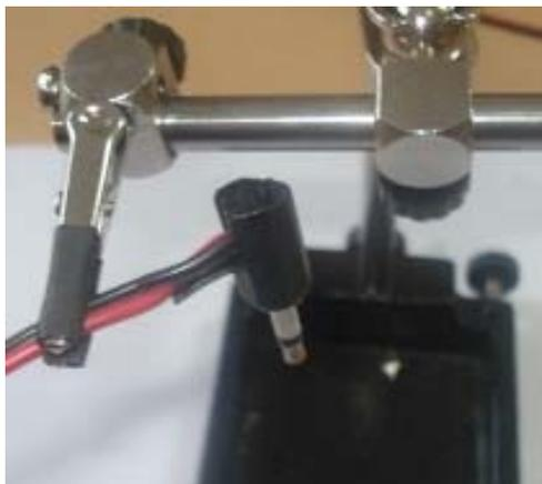
**Paso 4:** Luego de asegurarnos que no se produzca falso contacto, para ello probamos el pulsador en el teclado, pegamos con la pistola térmica el cable y la ficha.
