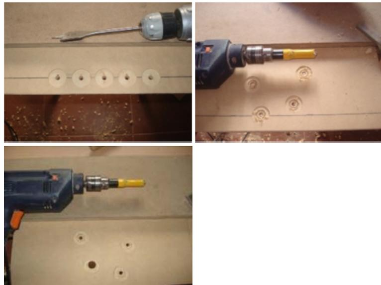
Nota: es importante que la tecla del pulsador sobresalga del nivel de la madera. En caso de necesitar gastar mucho la madera, para poder atornillar el pulsador, hacerlo del lado de atrás de la madera.
