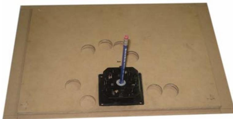
**Paso 5:** Luego de marcar los huecos de la madera la retiramos, y con una mecha paleta de 3cm gastamos unos 4mm la madera donde colocaremos los pulsadores.
