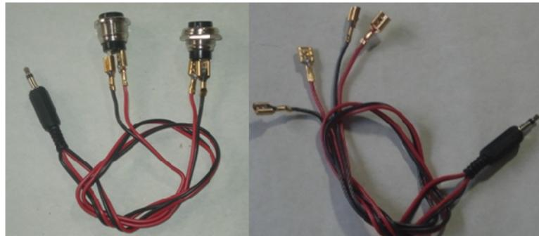
**Conexión para 1 o 2 pulsadores que permite activar una misma tecla, con 2 fichas tipo "plug" hembra mono.**
