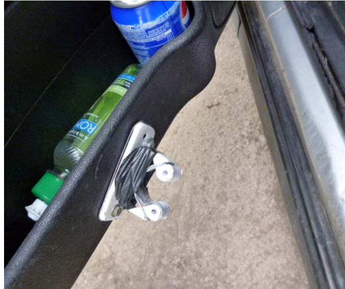
Detalle del anclaje de fregona fijado a la puerta del coche.
