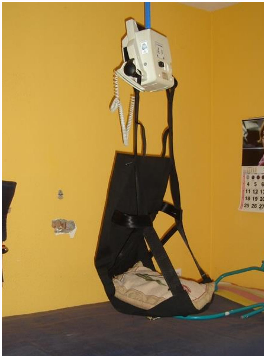
Arnés colgado de la grúa. Aquí se advierte perfectamente la disposición de las correas.
