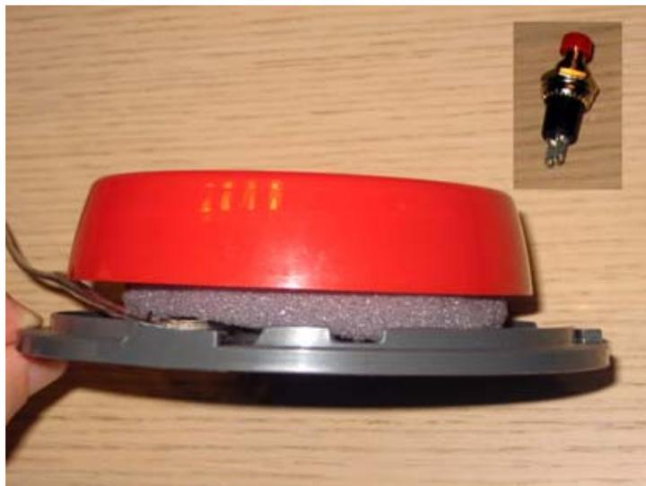
Vista lateral del pulsador y detalle del modelo de pulsador que se ha utilizado para la adaptación.
