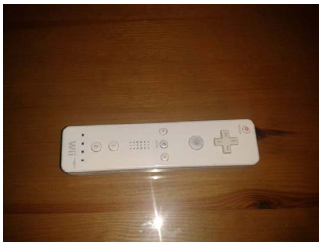
Mando de la Wii, encargado de captar, decodificar y enviar las señales emitidas por la LED en el ordenador.
