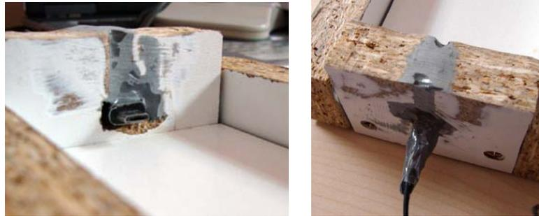
Cuando tenemos el teléfono pinchado a la clavija del cargador y antes de aplicar el pegamento es buena idea poner cinta aislante en el teléfono para protegerlo por si rebosa el pegamento y toca el teléfono. También es útil biselar los dos laterales de la base ya que facilitan la entrada del teléfono.
