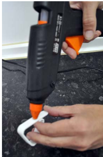
Dando silicona al clip para fijarlo en la base del vaso.
