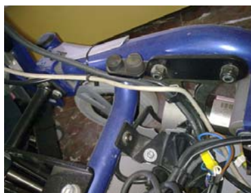
Fijación de los cables con las bridas.
