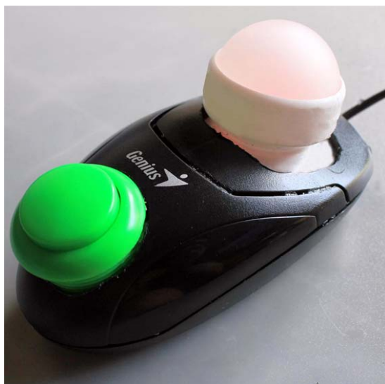
Ratón adaptado mediante una bola de desodorante tipo roll-on para ser activado como un TrackBall.
