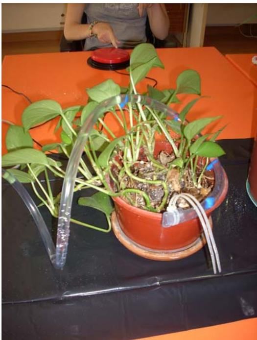
Nota: Si se invierte la polaridad de la conexión del transformador a la bomba, el agua no entra en el tubo, ya que la hélice funciona en sentido contrario. Esto se soluciona cambiando la conexión de los cables.
