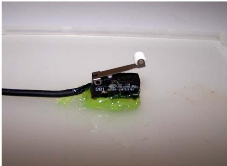
Detalle de la fijación del microinterruptor a la caja del CD.
