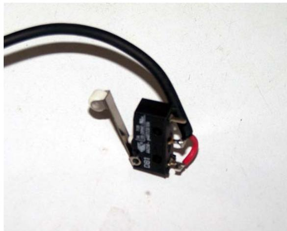
Imagen del microinterruptor con los cables soldados.
