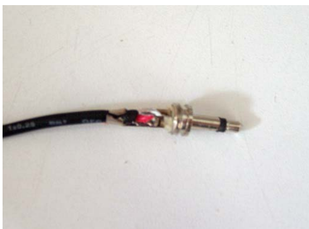
Soldadura del cable a jack.
