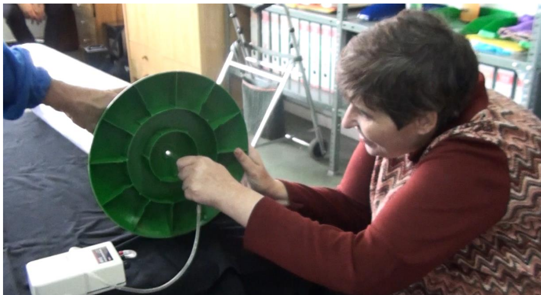
Perforamos la base e introducimos el tubo de la bomba de agua.
