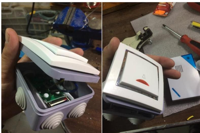
Cerramos la caja con el timbre encastrado a la misma y la placa con la pila de 12v dentro de la caja
