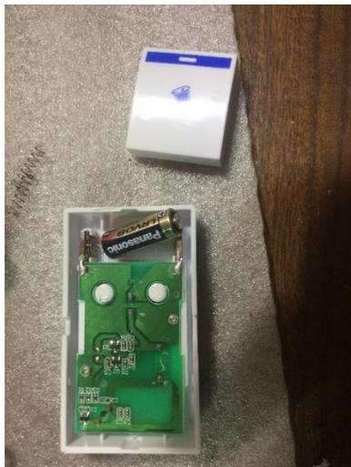
Probamos que todo funcione con la pila y lo pulsamos de forma manual, para saber que funciona, llevándonos el receptor a donde lo tengamos que usar, con sus pilas recién puestas
