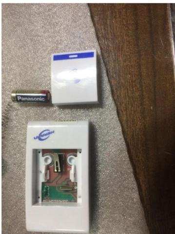
Se desarma el emisor o timbre (botón o pulsador), identificando el pulsador en la placa base con sus patillas de conexión
