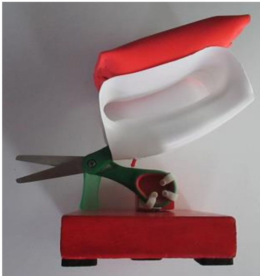
Tijeras adaptadas con agarre múltiple, terminadas.
