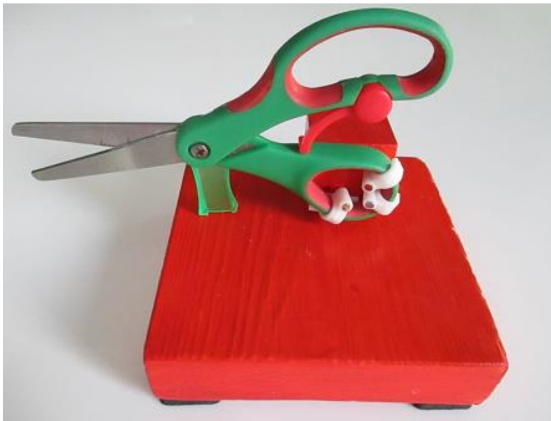
Tijeras adaptadas sin el agarre múltiple, terminadas.
