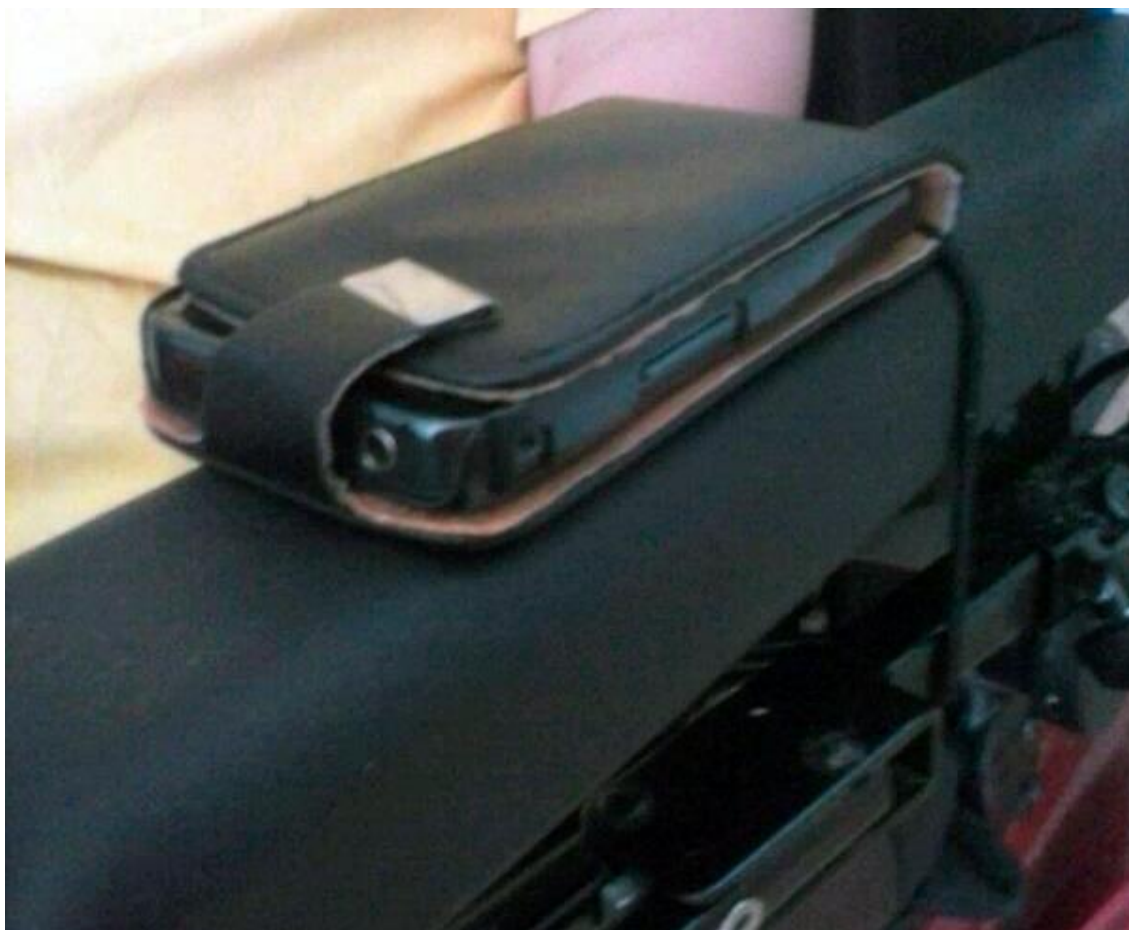
Imagen de teléfono móvil en su funda sujeto al brazo de una silla de ruedas.
