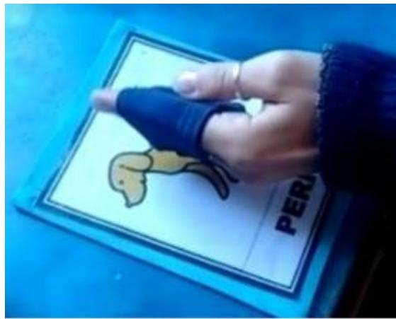
En la banda de menor potencia, se utilizaron 3 imanes de neodimio de 9 mm de diámetro y 2 mm de espesor.
