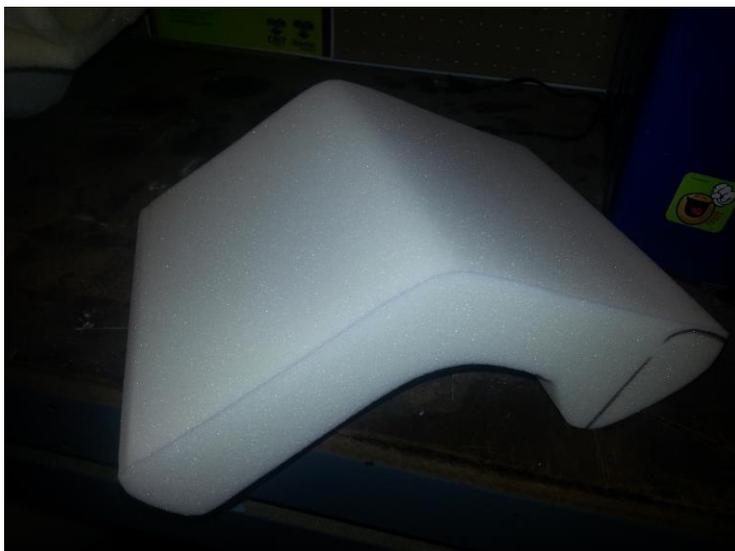
Cubo de espuma recortado según la plantilla realizada.
