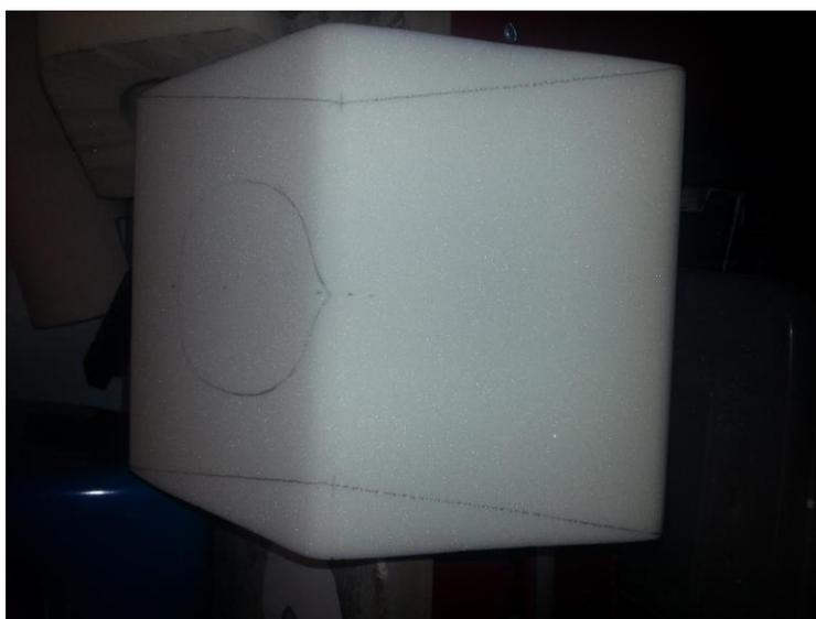
Cubo de espuma en el que se ha dibujado el soporte antes de ser cortado.
