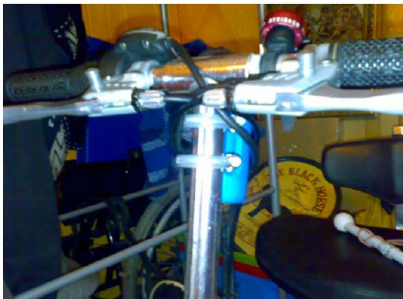
Detalle de como se ha sujetado el soporte del mástil a la barra del triciclo con dos bridas de fontanero. (se puede también instalar en una silla de ruedas).
