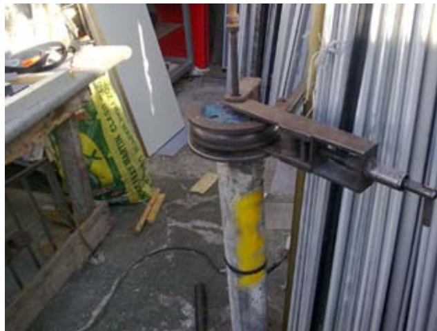
Dobladora en frío para el tubo de aluminio.
