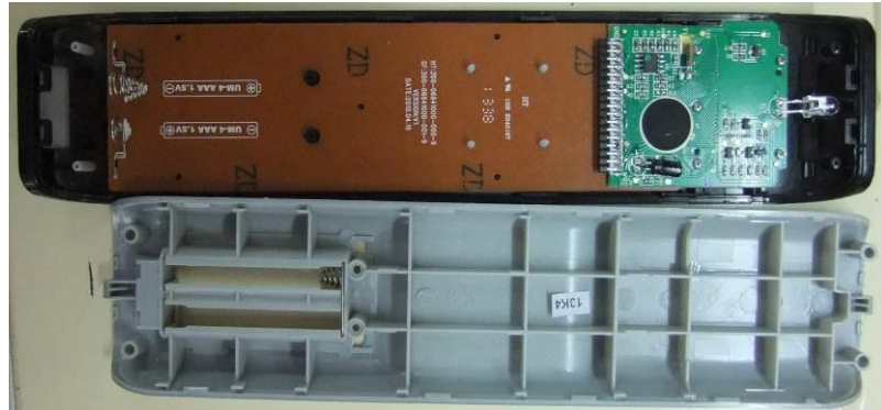
Figura: Interior del mando a distancia.
