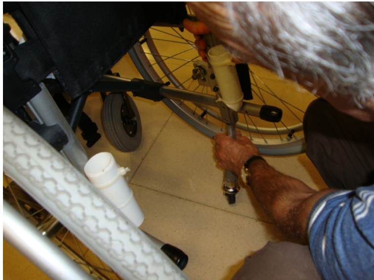
Colocación de la segunda rueda.
