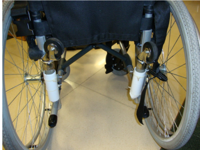
Imagen de las ruedas suplementarias recogidas en su soporte.
