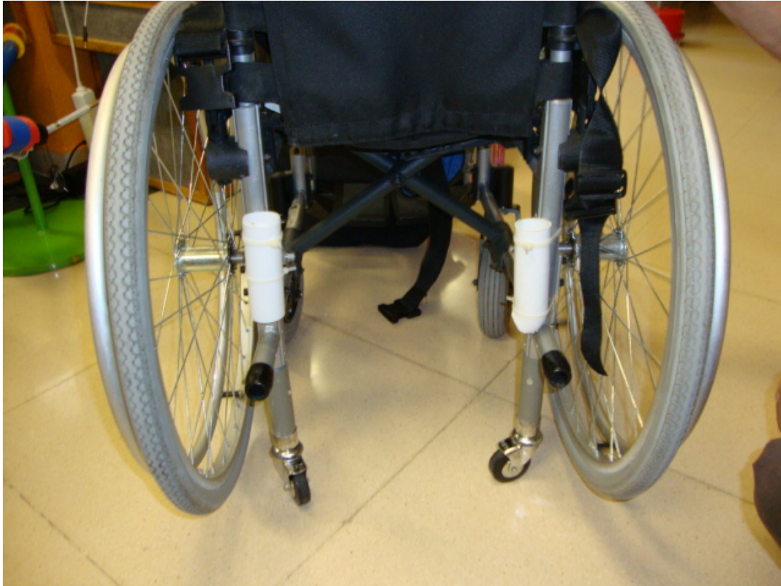
Imagen de las ruedas suplementarias colocadas en su posición de trabajo.
