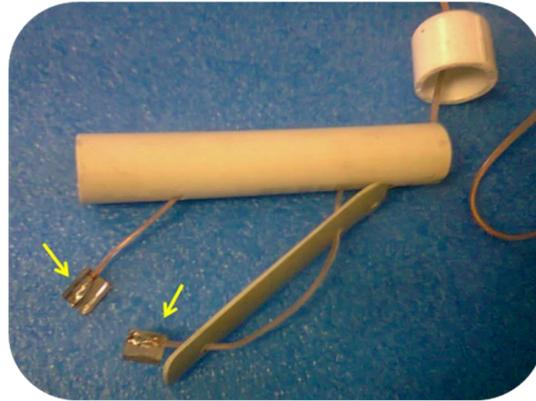
Después fijaremos estos dos tramos metálicos, ya con sus respectivos polos de cable soldados en ellos, a las paredes del tubo y lengüeta, según cada caso, para esto nos ayudaremos con un poco de silicón caliente.
