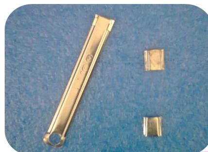
Y en el extremo del cable que sale por los orificio del tubo y lengüeta, vamos a soldar estos dos pequeños tramos metálicos, quedando de la siguiente manera:
