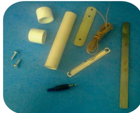
Su modo de funcionamiento es simple, consiste en realizar una ligera presión de mano sobre una sensible lengüeta que pone en contacto los dos polos de un cable eléctrico y con ello realizar la activación del pulsador.
