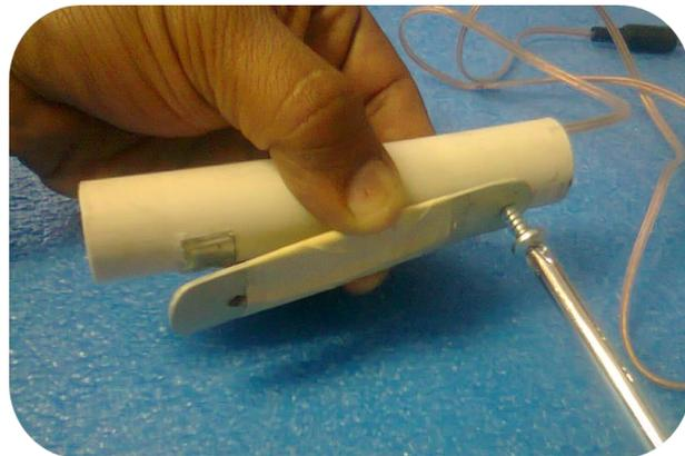
Y podemos apreciar como al meter por completo el tornillo, el doble que hicimos en un extremo de la lengüeta genera un espacio de separación entre las dos laminillas metálicas al otro extremo de la misma, cuando la lengüeta sea presionada por los dedos del usuario, ésta regresa sola a su posición de inicio gracias al resorte que se genera en el doblé.
