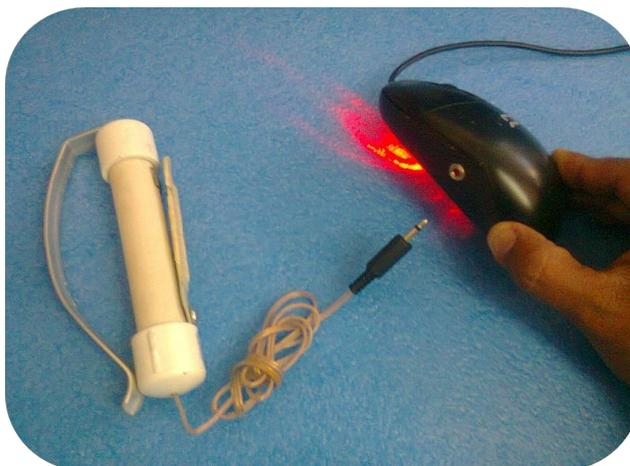
EL PULSADOR PUEDE SER UTILIZADO PARA ACCESO A LA COMPUTADORA POR MEDIO DE MOUSE ADAPTADO, EN JUGUETES ADAPTADOS, APARATOS ELECTRODOMESTICO CON PREVIA ADAPTACION, ETC.
