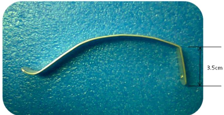
Posteriormente debemos fijar la varilla al pulsador usando nuestro segundo tornillo, esto será exactamente en el orificio del tapón, así:
