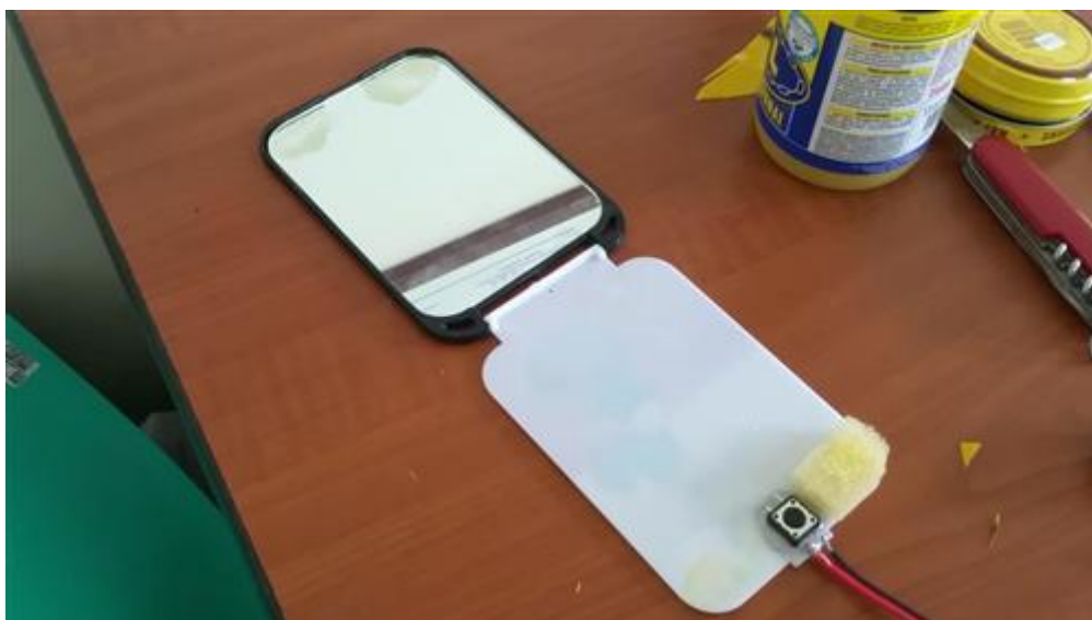
Colocamos espuma en los lados del microrruptor.
