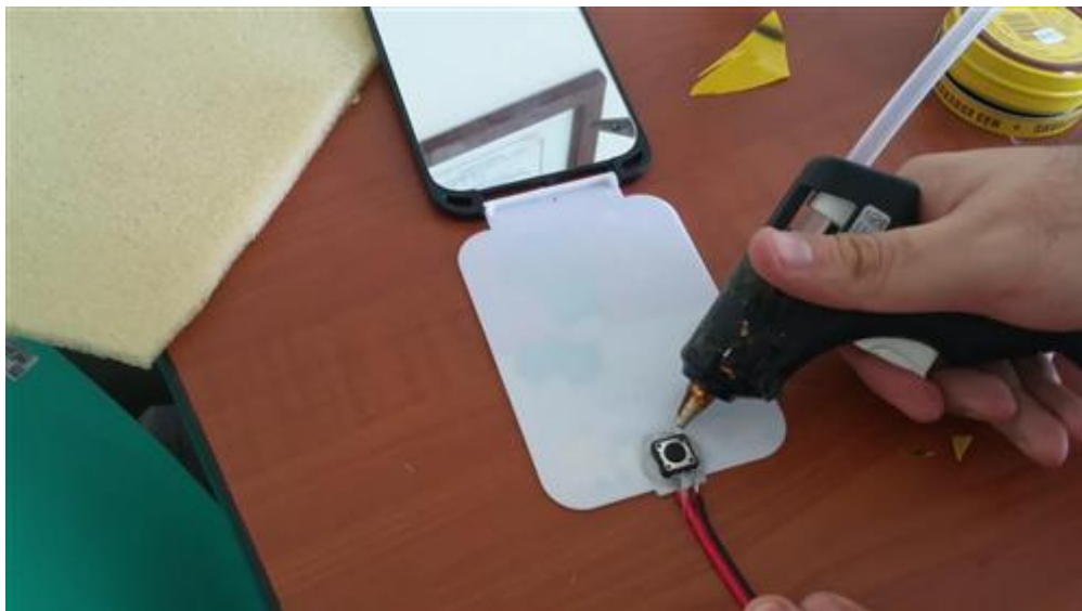
Pegamos el microrruptor a la tapa del espejo.
