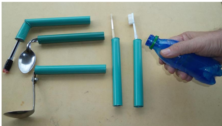
Conjunto de adaptadores para utensilios diversos junto con la botella a la que se adaptan.
