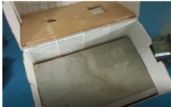
Imagen 8: Colocación de tableros en el suelo y techo para dar más peso y estabilidad a la estructura. En este caso es necesario que sea así, pero se puede diseñar más pequeña para que sea más fácil de manipular. Se realizan dos hendiduras que serán donde irán fijos el joystick y el pulsador.
