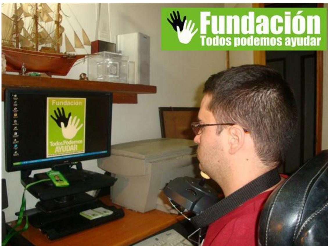
**Con algo de práctica y el movimiento de la cabeza u otra parte del cuerpo, este dispositivo con el apoyo de aplicaciones especiales que también entregamos, permite controlar íntegramente las funciones del mouse de una computadora, incluyendo el clic principal y el secundario, arrastrar, y hacer *scroll*. También es posible escribir usando el teclado virtual que aparece en pantalla.**
