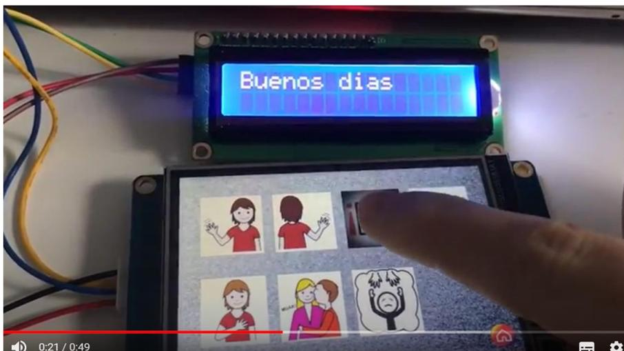
Captura a de una grabación de una prueba realizada en una de las pantallas táctiles pequeña y muestra el mensaje Alfanumérico en el Display de 16x2 caracteres. Se puede ver íntegramente en la web
