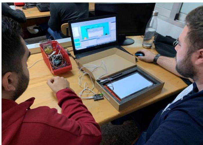
Pareja realizando pruebas de comunicación entre Arduino Mega, Pantalla Táctil y entorno de diseño Grafico
