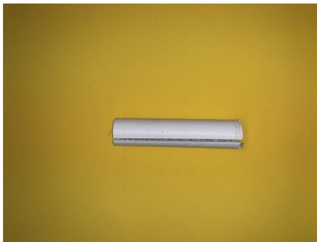
Columna de filamento flexible que funciona como resistencia para fija el sistema a la silla.
