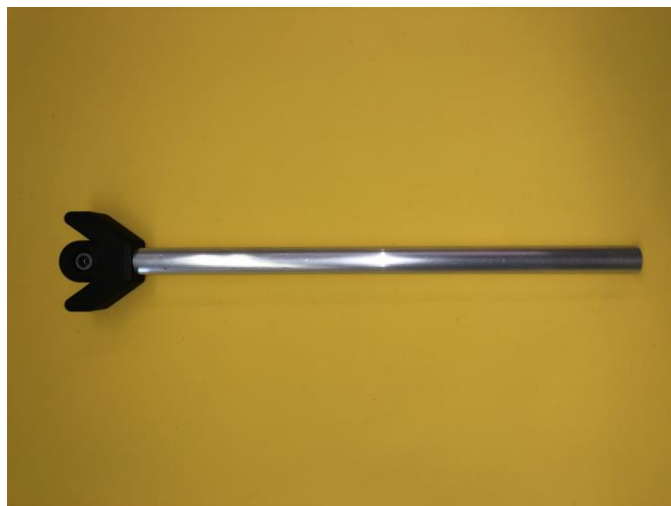
Barra de aluminio con topes para restricción de ángulos.
