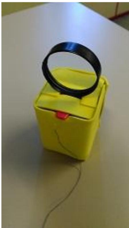
Una estructura en forma de cubo o prisma en una de cuyas aristas se coloca, sobresaliendo, el enhebrador. En el centro de la estructura, aproximadamente, se mete la lupa de manera que aumente la visión del enhebrador.
