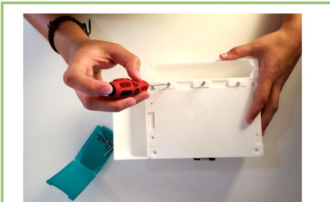
*Imagen 9:* Fijación de la tapa y de las rampas con la caja
