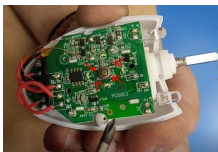
Imagen 2: Localizar el pulsador de la placa y extraerlo calentando las puntas con el estañador y tirando hacia arriba.
