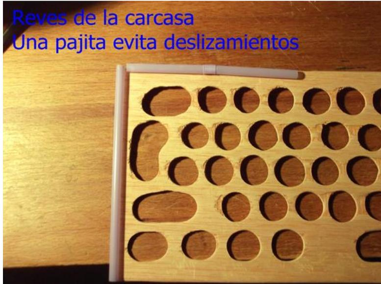
En el revés de la carcasa se aprecian las pajitas que aseguran la fijación al teclado.
