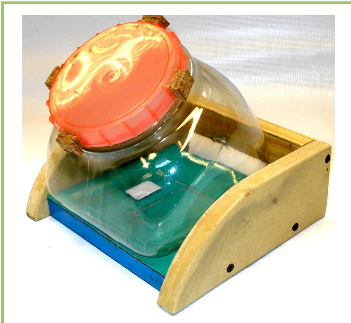
Imagen de base donde se coloca el bote que debe ser abierto. La base sujeta el bote en su posición y los añadidos de corcho de la tapa facilitan el agarre y el giro.
