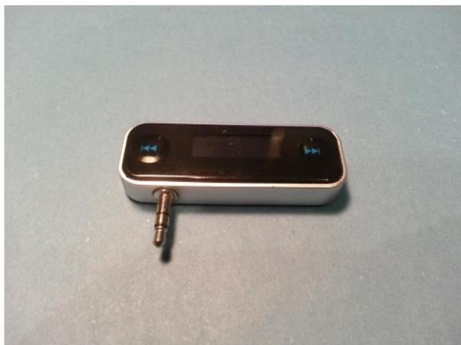
Ejemplo de un transmisor FM con clavija jack 3.5mm (esta clavija es la que llevan todos los auriculares).
