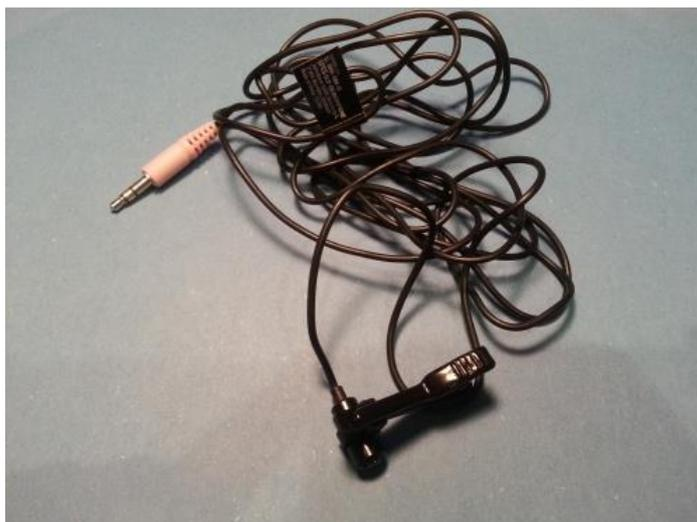
Ejemplo de un micrófono con jack 3.5mm y cierre de clip para ponerlo en la corbata, camisa, etc.
