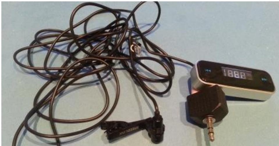
Conexión del micrófono y el transmisor FM al adaptador de audio.
