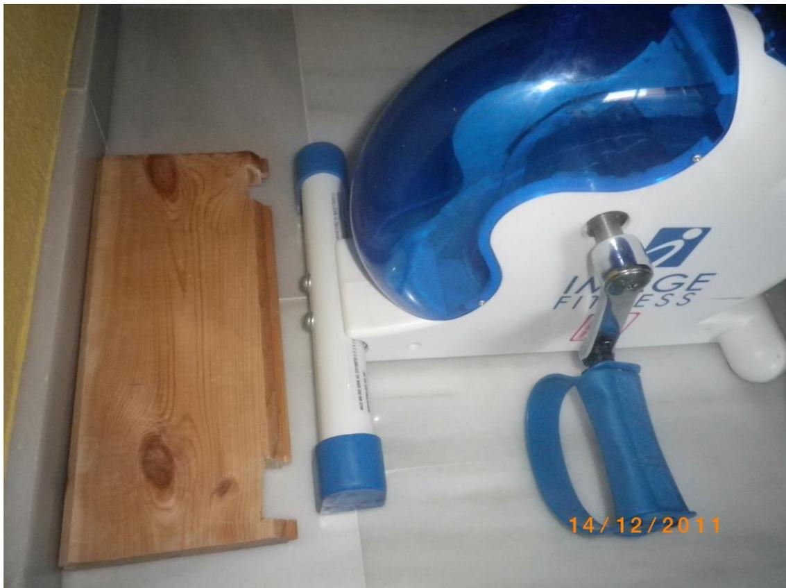
Tabla con escotaduras para servir de tope al pedaliar y fijarlo en una posición.
