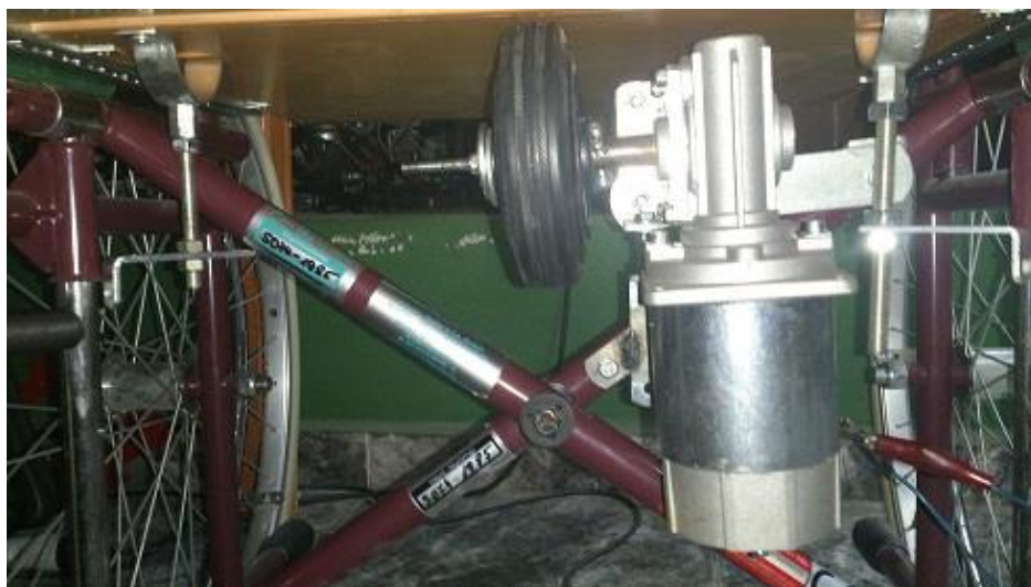
Parte inferior del asiento en la que se ve el motor que lo desplaza.
