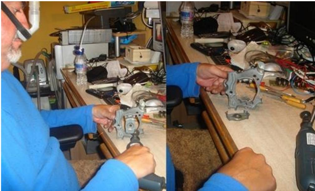
Cortando soporte metálico del motor con herramienta multiusos.
