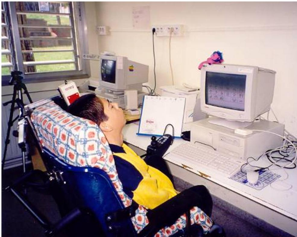
**Foto 2.** . Marc se comunica a través del programa **plaphoons** (selecciona los gráficos a través de un sistema de barrido automático, con un conmutador accionado con la cabeza)
